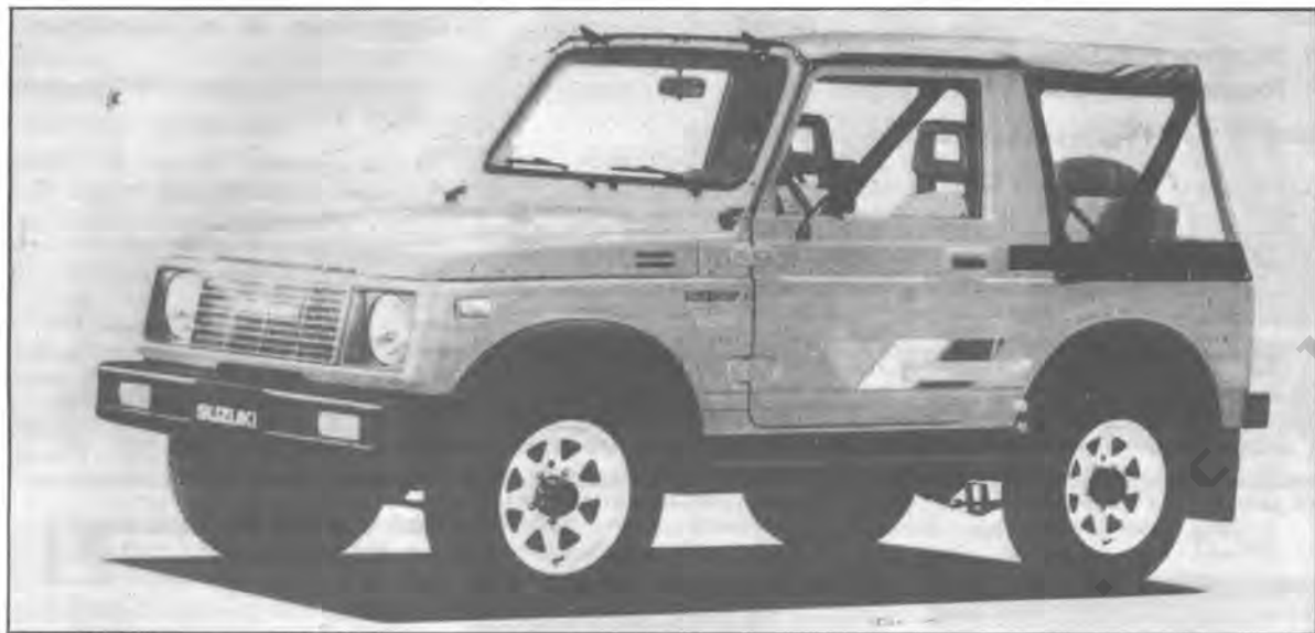
Suzuki SJ 413, motor de 1.324 cc. con tracción en las cuatro ruedas.
